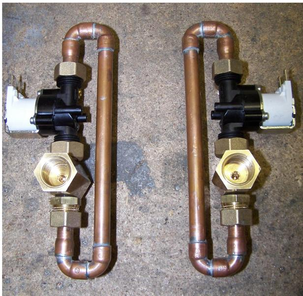
3. К трубе подачи воды прикрутить латунный шестигранник с трубками и клапаном как показано на рисунке (катушка клапана должна быть направлена наружу, а клапан должен быть над шестигранником).
